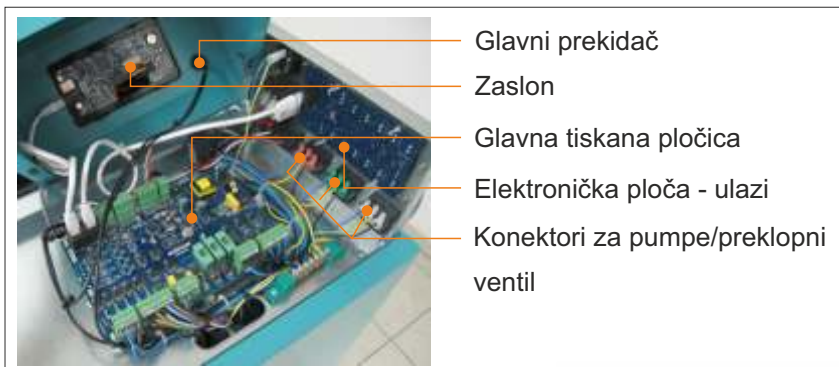
Slika 5. Konektori za priključenje napajanja, el. dijelova i osjetnika
